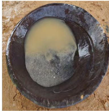
4b: 職人の鉱山での簡単な洗浄プロセスの例（写真: U. Schwela）
