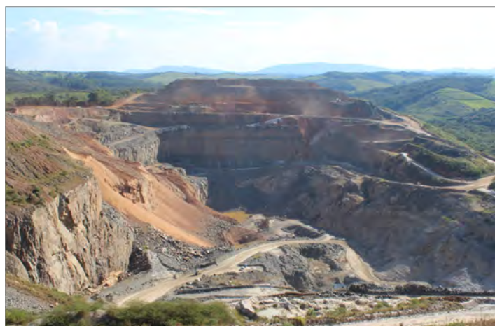
図9: ブラジルのミナスジェライス州にあるAMGミネラサン社のミブラ鉱山には、測定されたリソースと指定されたリソースが20.3 Mt含まれています。現在、年間約135トンのTa 2 O 5 を生産する能力があります（写真: T. I. C.）
